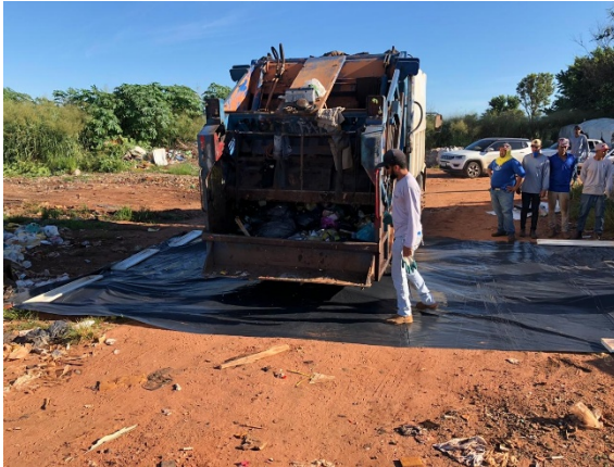
Figura 17 Preparação de descarregar o RSU na lona. Fonte: MN Consultoria e Soluções Ltda.
